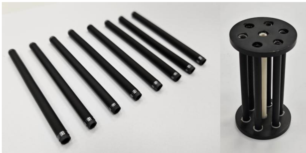
Рисунок 1 – Экспериментальные образцы трубчатых ТОТЭ.
