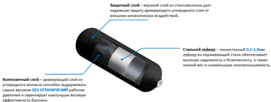
Рисунок 2. Конструкция баллона Сафит.
