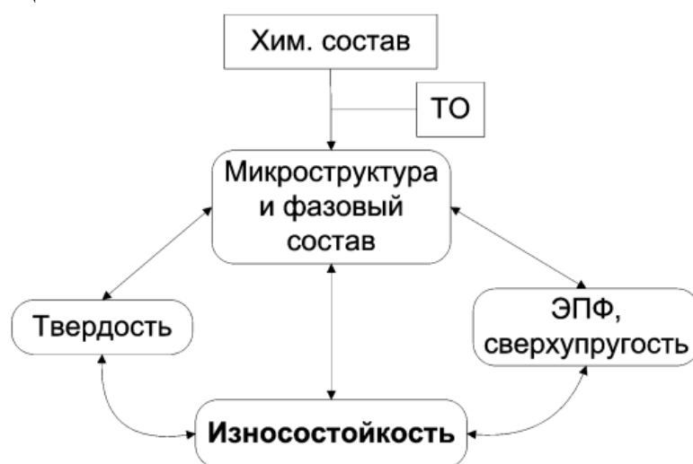
Рис. 1. Взаимосвязь износостойкости с исследованными параметрами бронз
