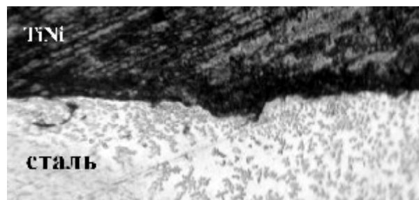
Рис.1. Зона соединения TiNi–сталь. x400.
