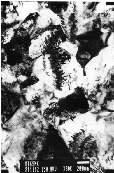
Рис. 1. Тонкая структура СМК сплава ВТ6 в исходном состоянии
