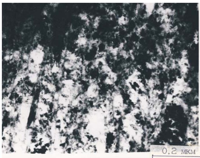
Рис. 2. Структура никелида титана после деформации на 50% \times 130000 .
