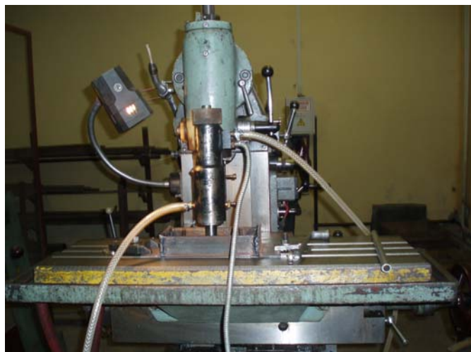
Рис. 1. Внешний вид установки для ультразвуковой импульсной упрочняющей обработки поверхности плоских деталей на фрезерном станке.
