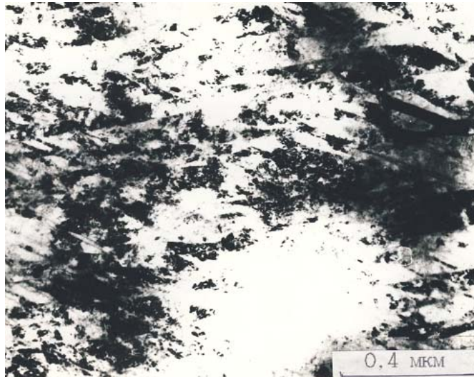
Рис. 1. Структура никелида титана после деформации прокаткой на 25% \times 75000 .
