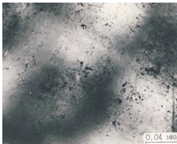
Рис. 3. Структура никелида титана после деформации прокаткой до 90% \times 500000 .
