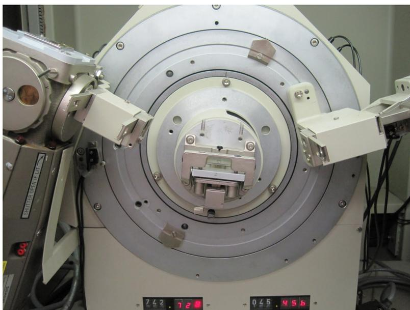
Рис.7. Гониометр порошкового дифрактометра Siemens D500 со снятым криостатом.
