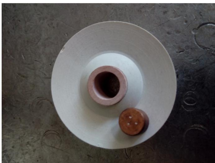
Рис. 1. Контейнер из литографского камня с пирофиллитовой втулкой и медной ячейкой.
