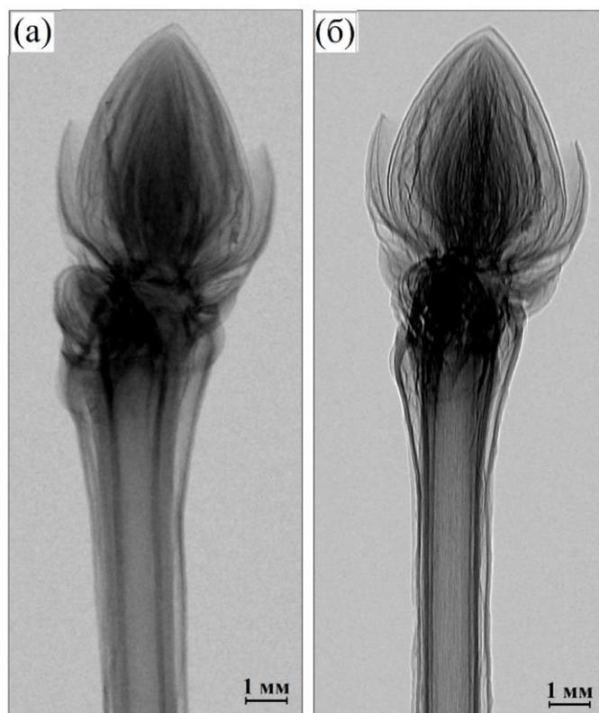
Рисунок 3.4: Рентгеновские снимки почки кустарника, полученные в режиме: а – абсорбционного контраста ( $R_1 = 1500$ ,  $R_2 = 0$  мм), б – фазового контраста ( $R_1 = 1500$ ,  $R_2 = 400$  мм).
