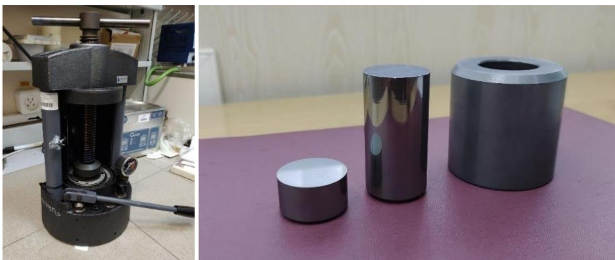
Рисунок 2.14 – Лабораторный гидравлический пресс (слева) и цилиндрическая пресс-форма (справа).
