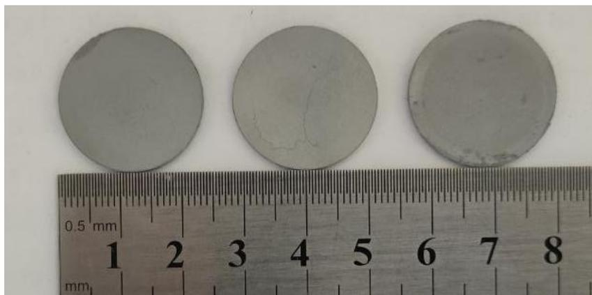
Рисунок 2.16 – Серия подложек из металла марки X17H2, сформированных методом одноосного прессования и отожженных в вакууме.
