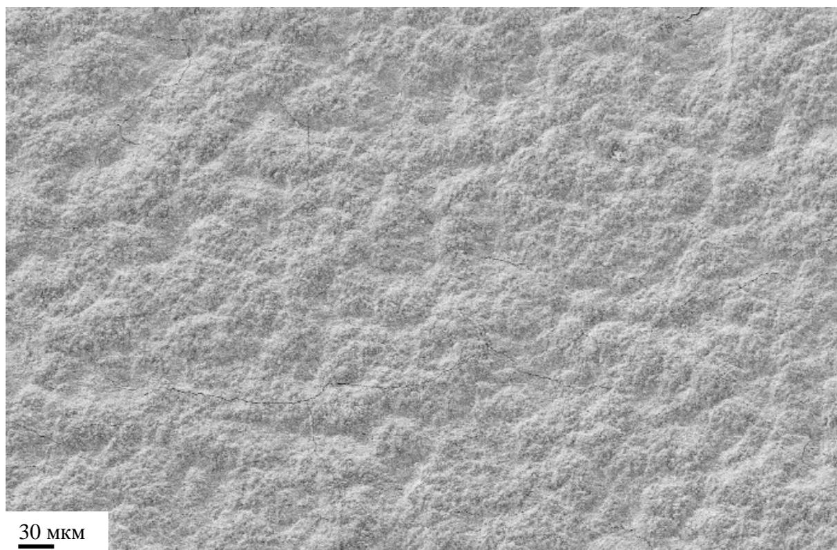
Рисунок 4.11 – СЭМ-изображение поверхности функционального анода Ni/GDC, осажденного методом АД и обожжённого в вакууме при температуре 1000 °С.
