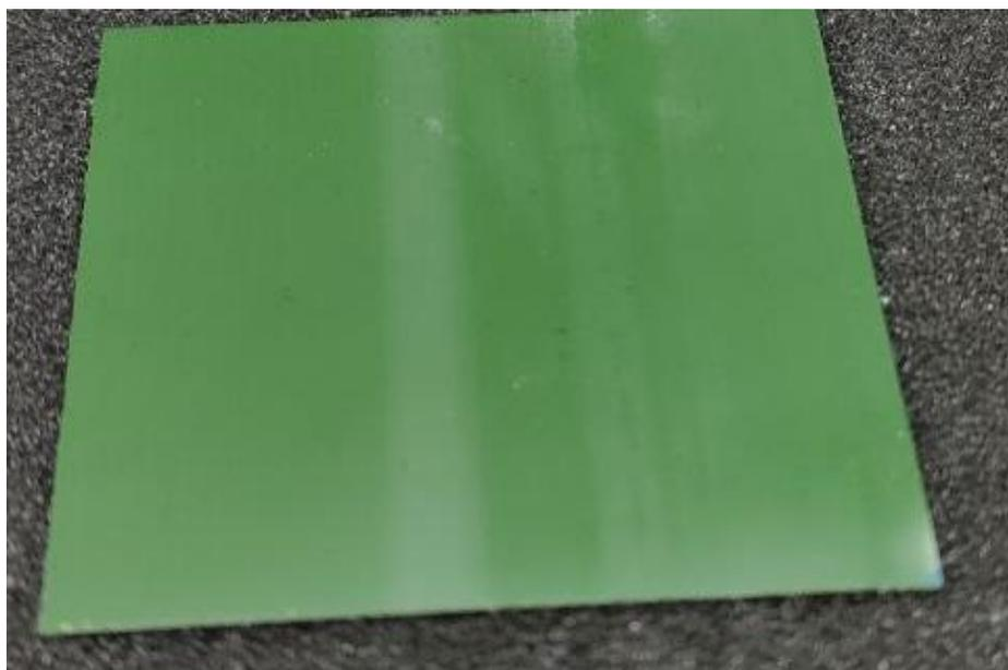
Рисунок 3.13 – Фотография анодной подложки размером  $50 \times 50$  мм после осаждения электролита 8YSZ методом AD.
