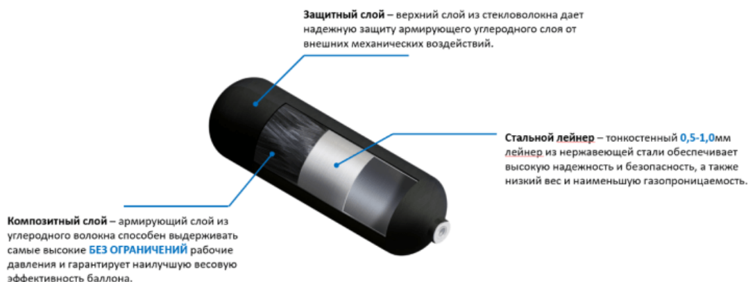
Рисунок 2. Конструкция баллона Сафит.
