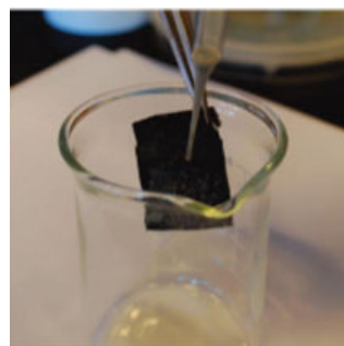
Рис. 3. Добавление нанопроволочек серебра к хлопку, пропитанному УНТ. Полученный материал вставляется в воронку, как показано на рис. 2.
