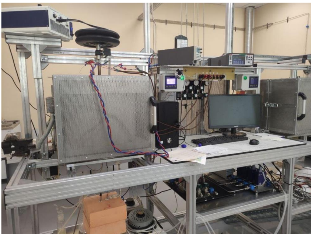
Рис. 6 – Фотография исследовательского стенда, включающего горячую зону и системы газораспределения и исследования электрохимических характеристик.
