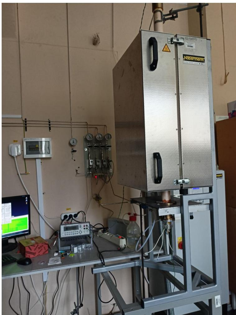
Рис. 8. Установка для измерения полужайки в атмосфере  $H_2$
