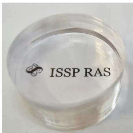
Рисунок 17 – Кристалл сапфира диаметром 32 мм, выращенный методом NCS.
